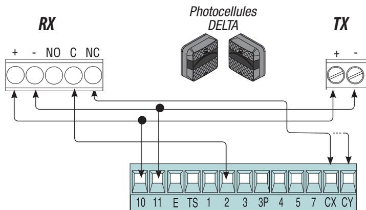
Configurez le contact CX ou CY (N.C.), entrée pour dispositifs de sécurité type bords sensibles conformes à la norme EN 12978. Voir fonctions entrée CX (Fonction F2) ou CY (Fonction F3) en :
