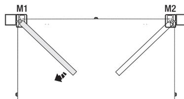
**N.B. :** avant d'effectuer le calibrage de la course, contrôlez s'il n'y a pas d'obstacle dans la zone de manœuvre et assurez-vous de la présence d'une butée d'arrêt mécanique en ouverture et une en fermeture.
