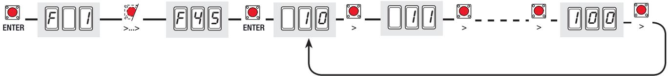
**F 46 (Numéro des moteurs) :** configuration du numéro des moteurs raccordés à l'armoire de commande.
