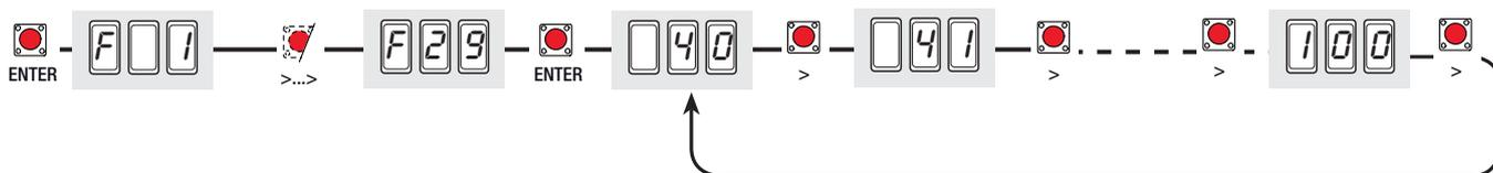
**F 30 (Vitesse de ralentissement du moteur M1) :** configuration de la vitesse pendant les ralentissements du moteur M1, calculée en pourcentage.
