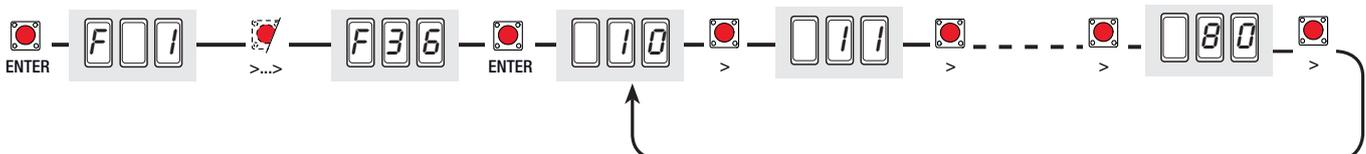
**F 37 (Point de ralentissement ouverture du moteur M1) :** elle règle le point de début du ralentissement du moteur (M1) avant le fin de course d'ouverture. Le point de début du ralentissement est calculé en pourcentage sur la course complète du vantail (voir par illustration des zones et des points de ralentissement et de déplacement)
