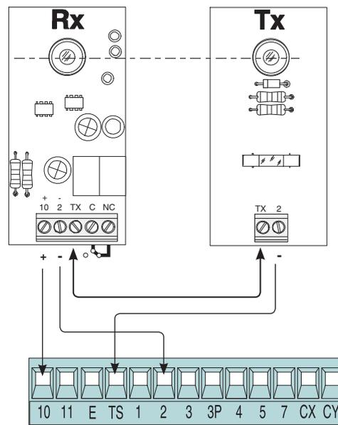
A chaque commande d'ouverture ou de fermeture, la carte contrôle l'état de fonctionnement des dispositifs de sécurité (photocellules). Une anomalie éventuelle des photocellules est signalée sur la carte électronique et elle annule n'importe quelle commande de l'émetteur radio ou du bouton.
