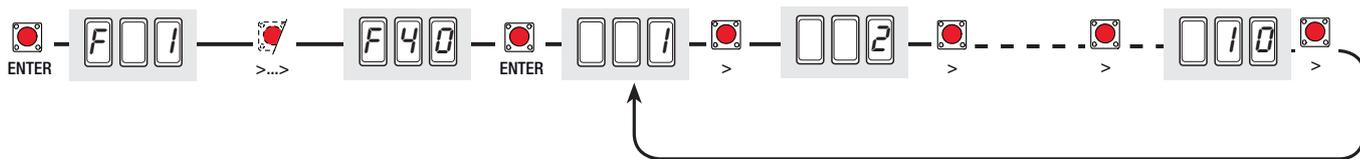
**F 41 (Point de ralentissement ouverture du moteur M2) :** elle règle le point de début du ralentissement du moteur (M2) avant le fin de course d'ouverture. Le point de début du ralentissement est calculé en pourcentage sur la course complète du vantail (voir par illustration des zones et des points de ralentissement et de déplacement)
