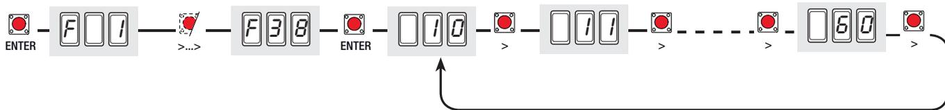
**F 39 (Point de déplacement ouverture du moteur M1) :** elle règle le point de début du déplacement du moteur (M1) avant le fin de course d'ouverture. Le point de début du déplacement est calculé en pourcentage sur la course complète du vantail. (voir par illustration des zones et des points de ralentissement et de déplacement)
