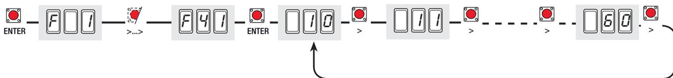
**F 42 (Point de ralentissement fermeture du moteur M2) :** elle règle le point de début du ralentissement du moteur (M2) avant le fin de course de fermeture. Le point de début du ralentissement est calculé en pourcentage sur la course complète du vantail. (voir par illustration des zones et des points de ralentissement et de déplacement)
