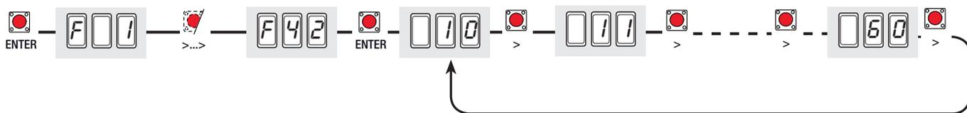
**F 43 (Point de déplacement ouverture du moteur M2) :** elle règle le point de début du déplacement du moteur (M2) avant le fin de course d'ouverture. Le point de début du déplacement est calculé en pourcentage sur la course complète du vantail (voir par illustration des zones et des points de ralentissement et de déplacement)
