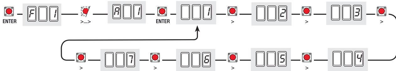
**A 2 (Test moteurs) :** activation du test pour vérifier si le sens de rotation des motoréducteurs est correct (voir paragraphe "test moteurs")
