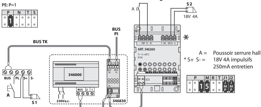
Système Audio ou vidéo avec alimentation réf. 346000: câblage en entrée-sortie vers le PE.
