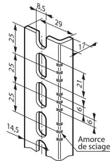
(1) Amorce de sciage pour longueur de montants au pas de 25. Les deux autres permettent d'obtenir la longueur des montants Réfs. 0 361 50/51/52/53/54/55/56.
