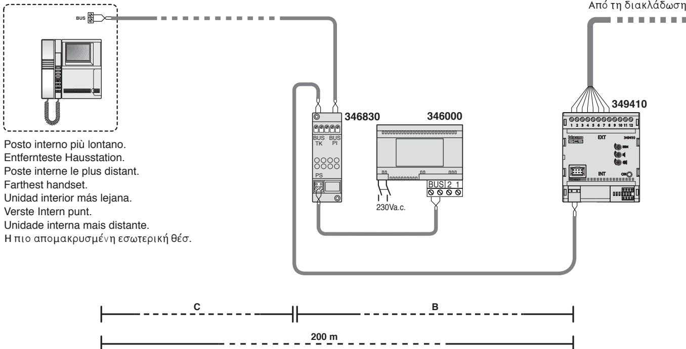
**I** Per il dimensionamento delle tratte **B** e **C** fare riferimento alla "Guida Tecnica Comunicazione" del sistema 2 Fili Video. Le tipologie impiantistiche realizzabili sul lato 2 fili sono quelle relative agli impianti monofamiliari. Per il cablaggio e per i limiti di sistema l'interfaccia art. 349410 è da considerarsi come un posto esterno.
