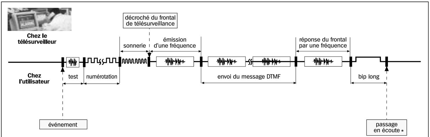
\* Pour pouvoir écouter ce qui se passe dans les locaux protégés afin de confirmer l'alarme, la programmation du type de transmission de la centrale doit être paramétré avec écoute et interpellation active. Pour faciliter l'écoute, la sirène de la centrale s'arrête pendant la période d'écoute.
