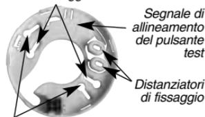
*Fori di fissaggio di diametro 85*
