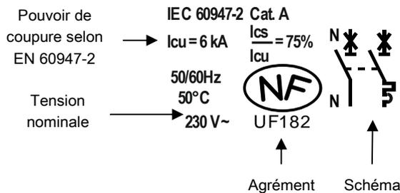
. Les bornes amont et aval du pôle neutre sont repérées par un « N » moulé à proximité des têtes de vis.
