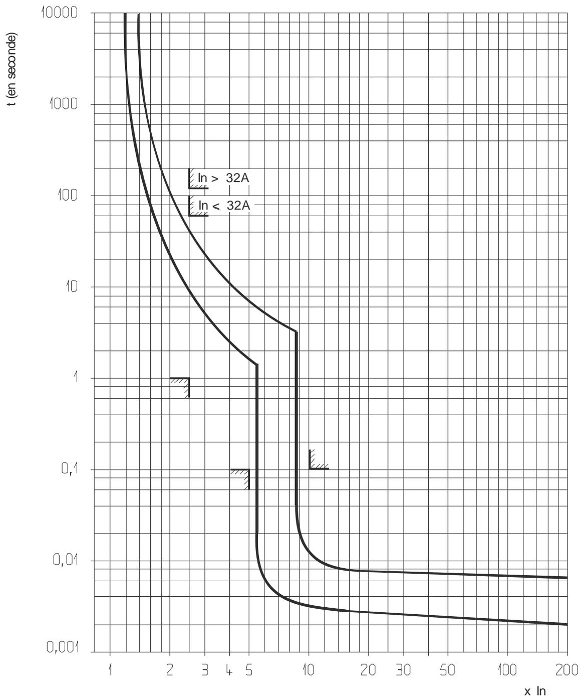
Déclenchement thermique temp. ambiant = 30°C
