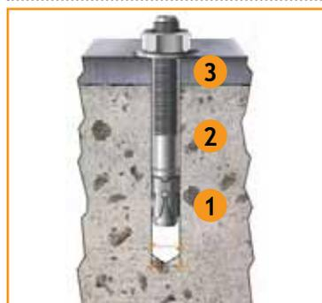
ATE Option 1, l'homologation la plus exigeante, permettant son utilisation pour du béton fissuré ou non fissuré, fort C50 et faible C20.
