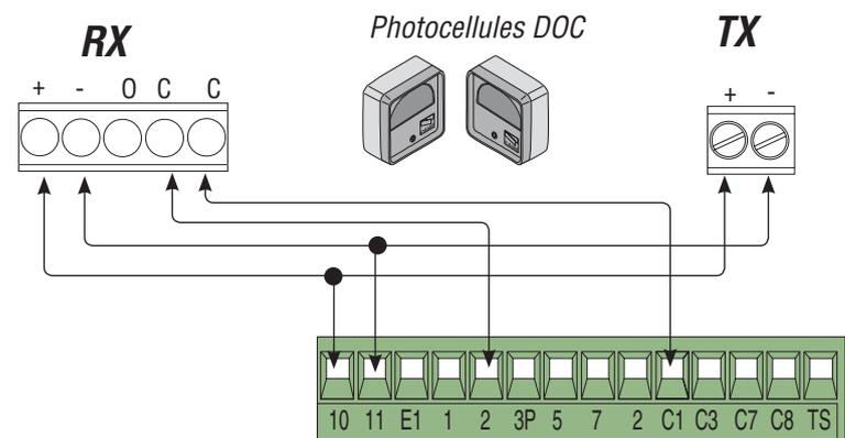
**Contact (N.C.) de «réouverture pendant la fermeture»**
