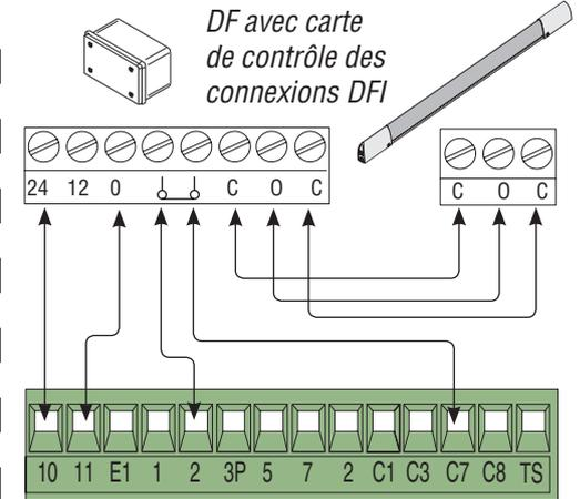
**Contact (N.C.) de « ré enclenchement de la fermeture pendant l'ouverture »**
