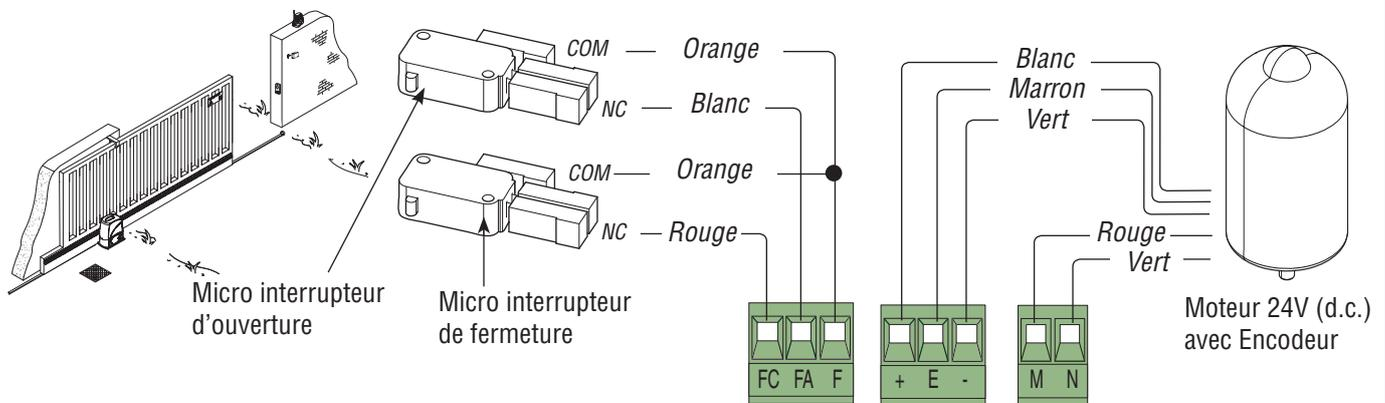
Modifications des connexions électriques pour installation à droite
