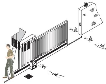
**⚠ (1) Attention :** après 3 détections d'obstacles consécutives, le portail s'arrête en ouverture et la fermeture automatique est éliminée ; pour reprendre le mouvement il faut appuyer sur le bouton de commande ou utiliser l'émetteur.
