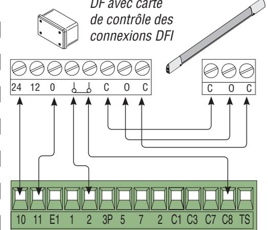
**6.4 Connexion électrique pour le fonctionnement du test de contrôle de sécurité des photocellules**
