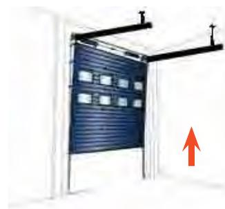
**4** Faire une course complète de fermeture en utilisant (< >) pour arriver au point maximal de fermeture.
