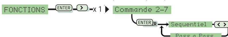
Fonction utilisateur : Impose la commande uniquement d'ouverture ou la fonction associée à la commande 2-7 à l'utilisateur.
