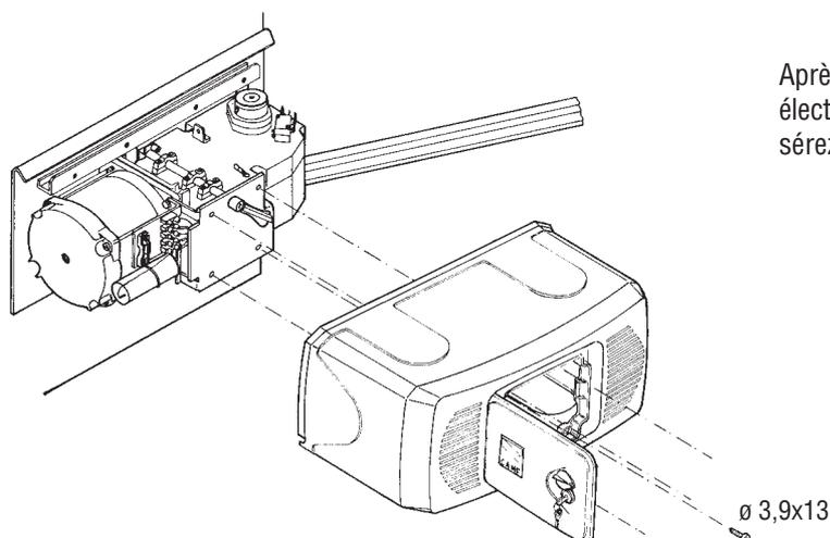
Après avoir terminé les opérations de montage, les connexions électriques et les réglages, bloquez de nouveau le moteur et insérez le couvercle en le fixant avec les quatre vis fournies.
