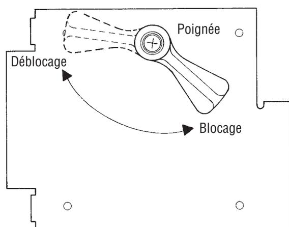
En cas de coupure d'électricité ou de pannes, débloquent le motoréducteur en utilisant la poignée prédisposée.
